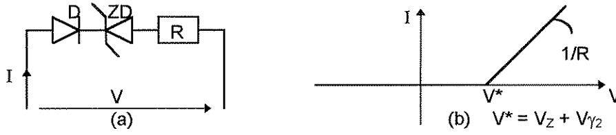
Şekil - 5 : (a) Diyot, zener diyot ve direncin seri bağlantısı, (b) Seri bağlı üç elemanın i-v özeğrisi
